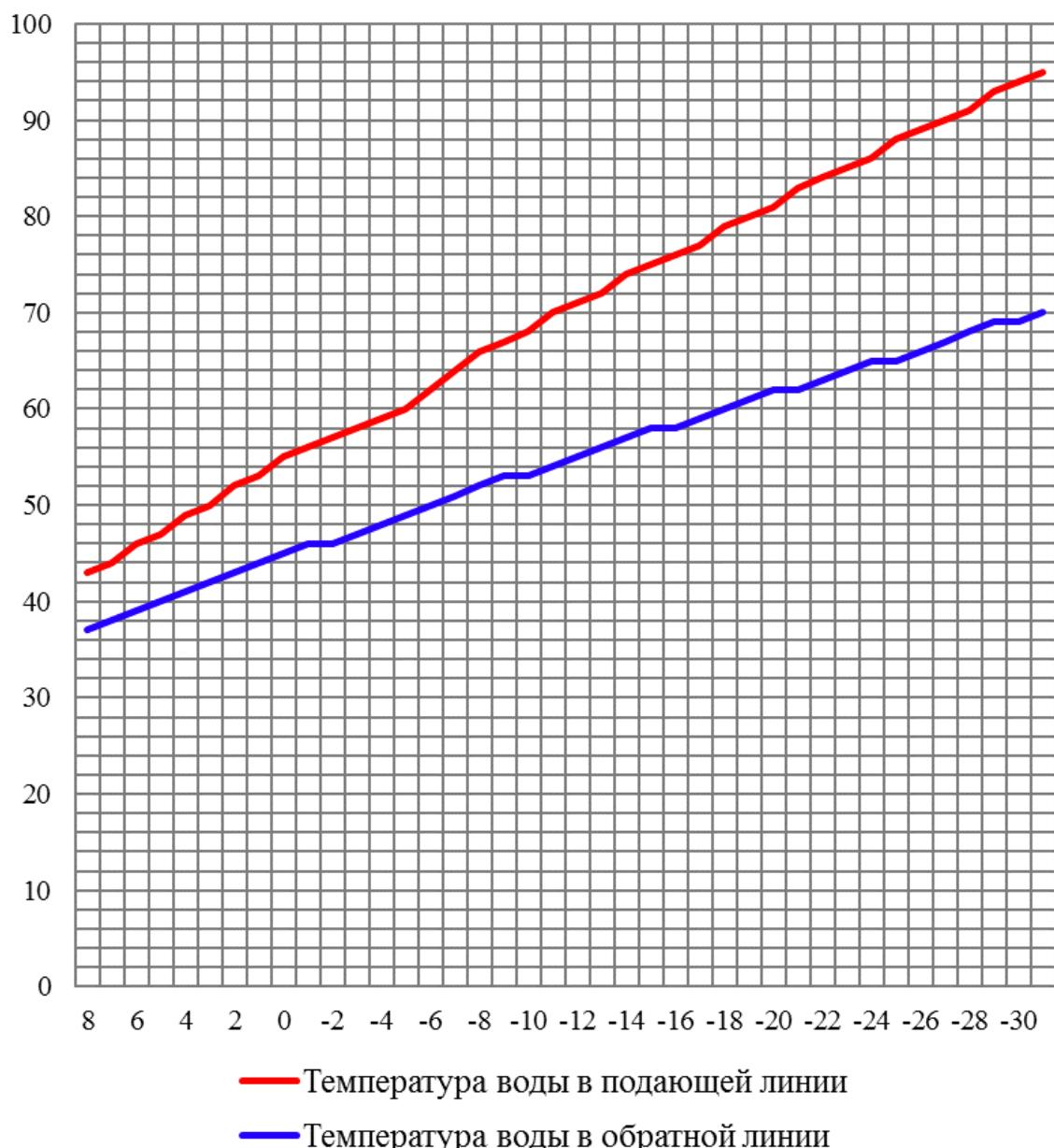
**Рисунок 8 – Графическое представление температурного графика**
