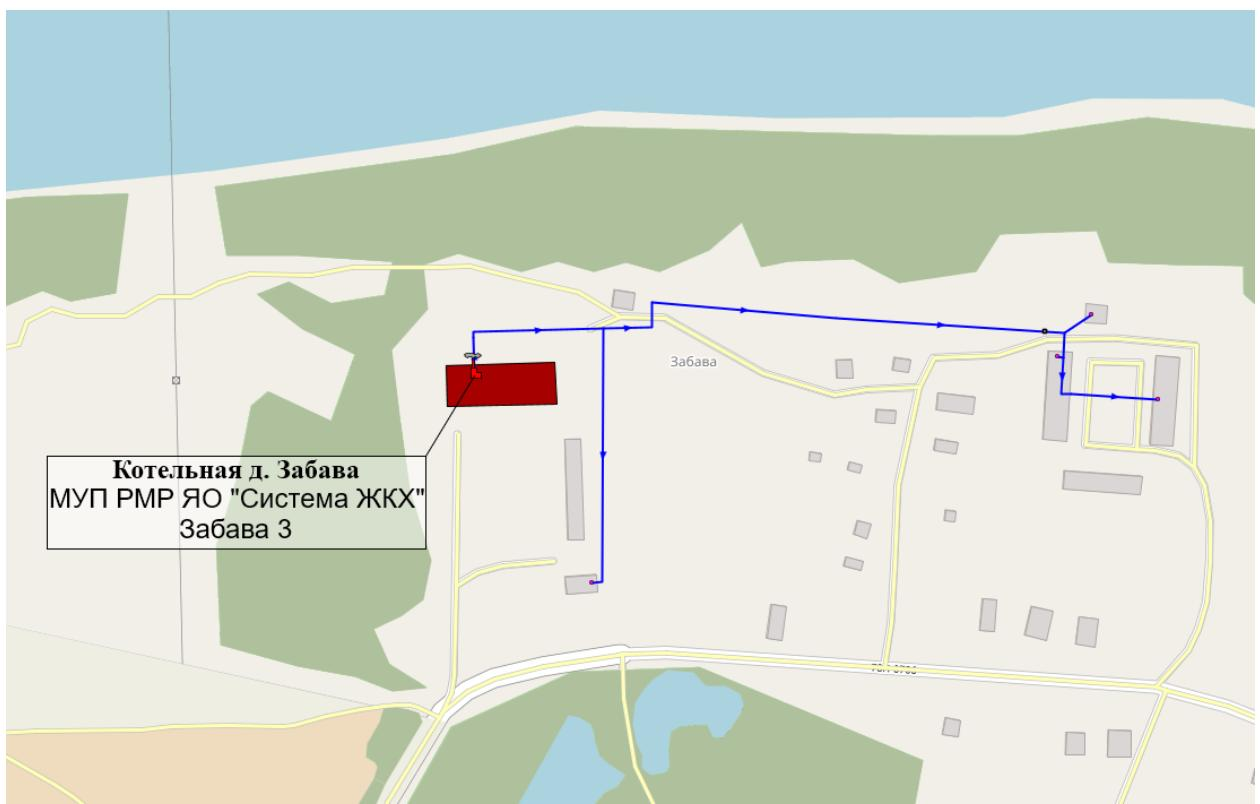
Рисунок 6 – Схема тепловой сети от котельной д. Забава
