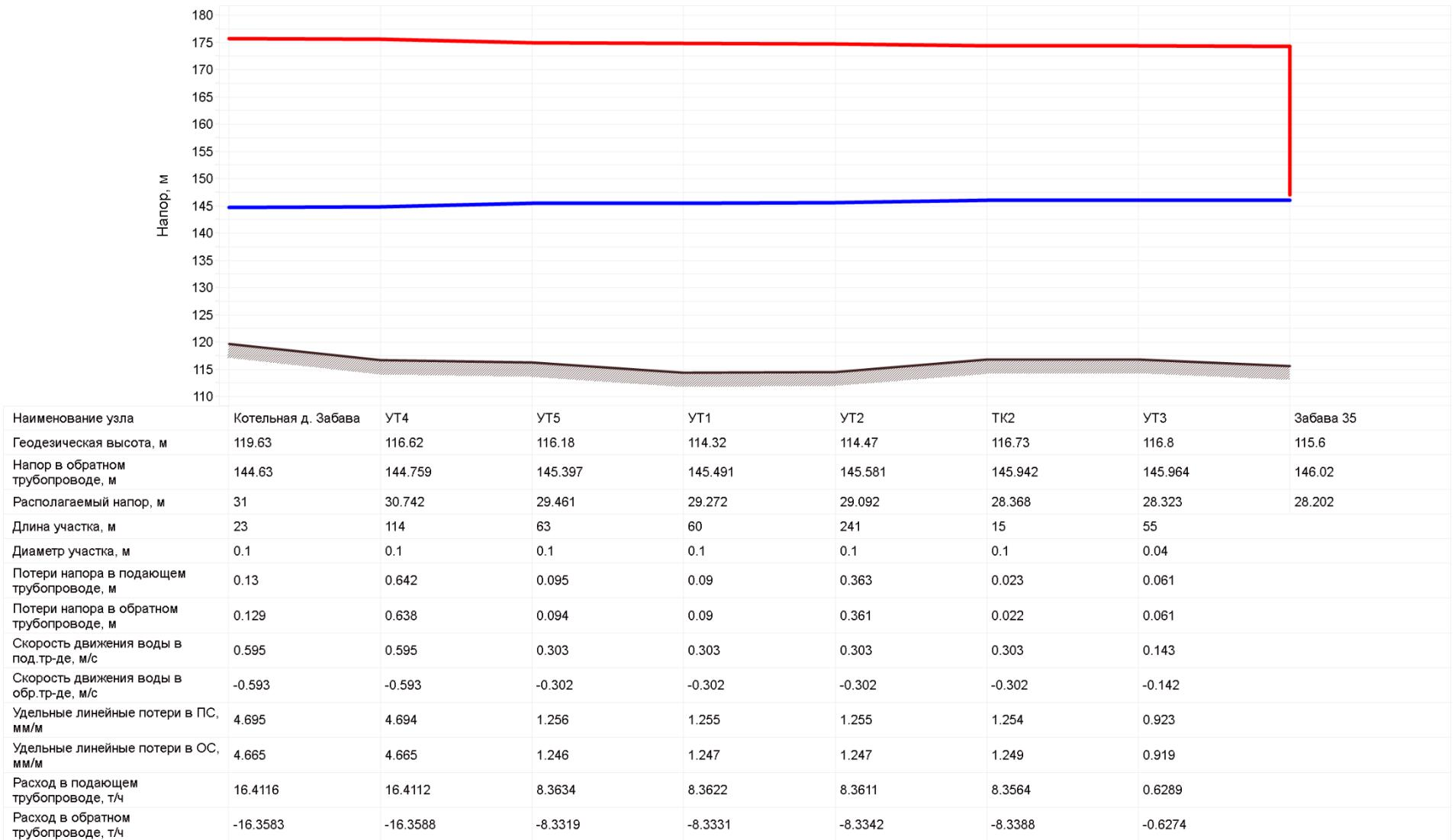
Рисунок 13 – Пьезометрический график от котельной д. Забава
