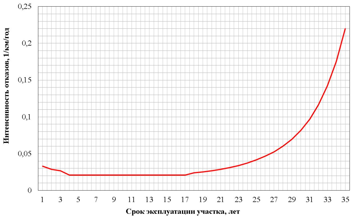
**Рисунок 15 – Интенсивность отказов в зависимости от срока эксплуатации участка тепловой сети**
