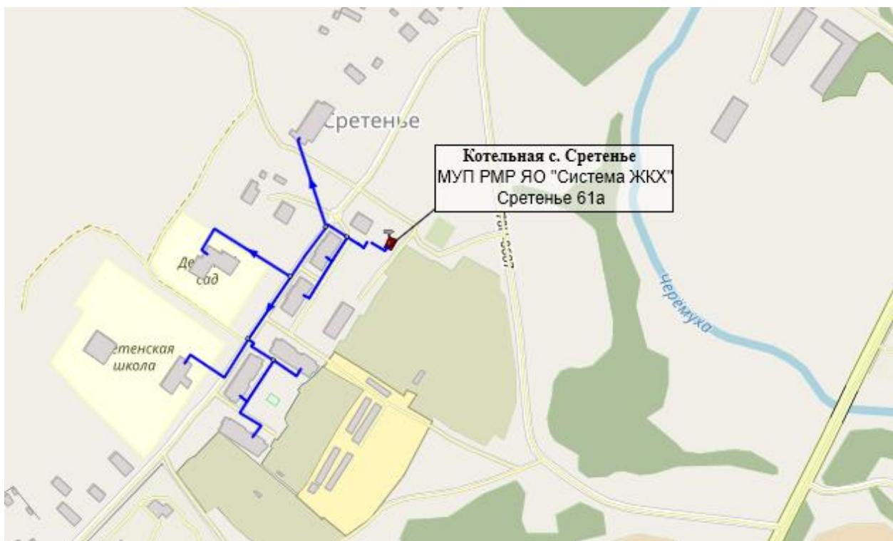
**Рисунок 7 – Схема тепловой сети от котельной с. Сретенье**
